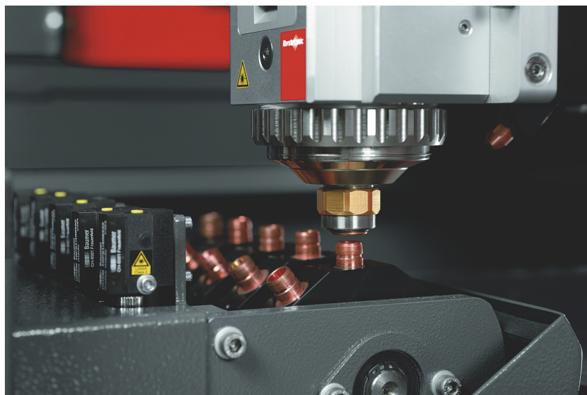
Dettaglio sistema cambio ugelli automatico su impianto taglio laser fibra Bystronic BySprint Fiber 6520.
